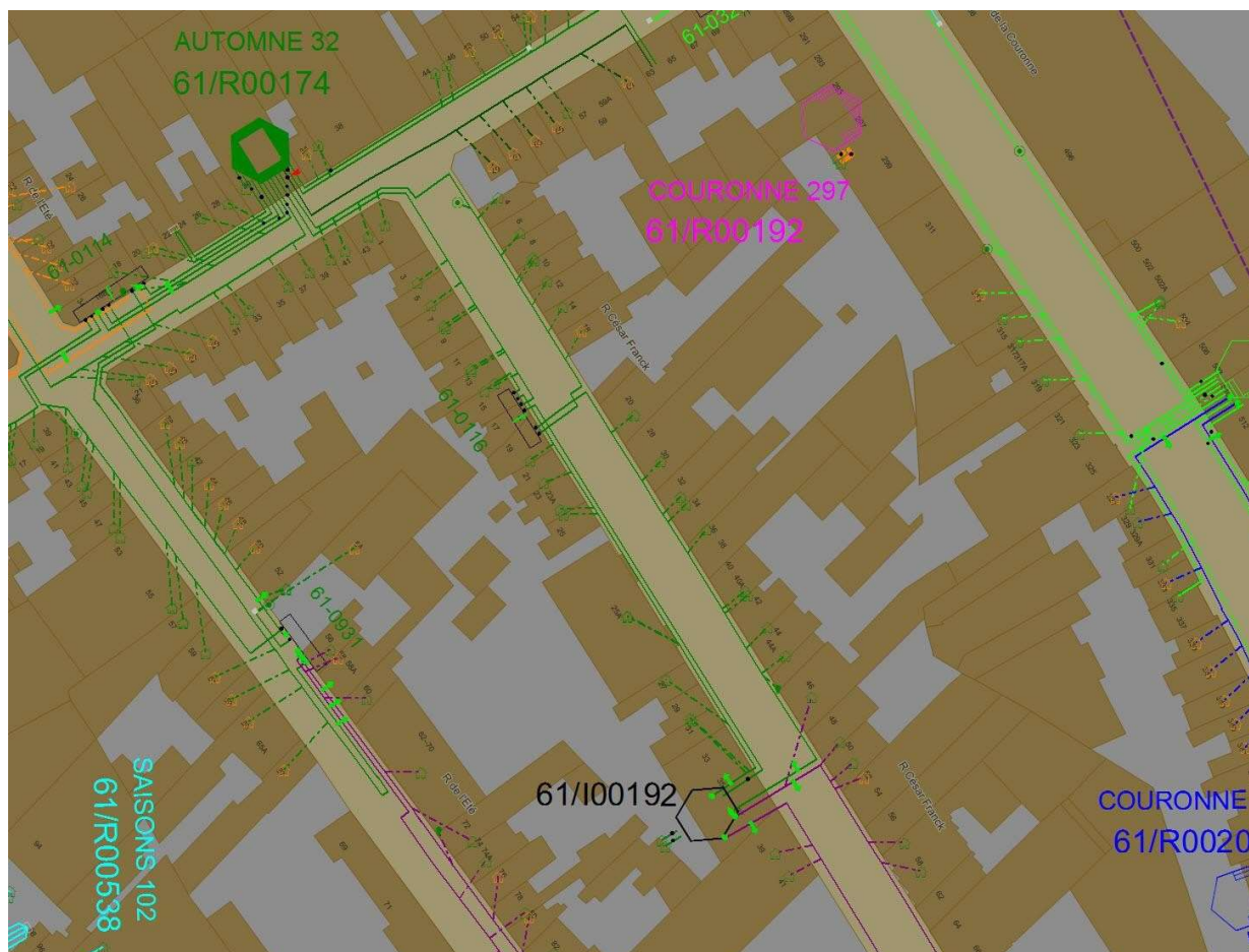
Figuur 29: Weergave van het LS-net in het DMS De kabels zijn ingekleurd in functie van de voedingsbron. Na een schakeling wordt de kleur automatisch aangepast.
